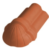
Grat-Anfangsziegel Nr. 1001 Decklänge: ca. 370 mm Deckbreite: ca. 210 mm Gewicht: ca. 3,2 kg
