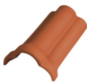
First Nr. 1000 Decklänge: ca. 375 mm Deckbreite: ca. 210 mm Bedarf: ca. 2,7 pro m Gewicht: ca. 3,4 kg
