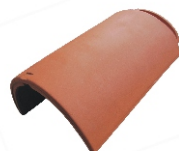
First Nr. 3000 Decklänge: ca. 385 mm Deckbreite: ca. 275 mm Bedarf: ca. 2,7 pro m Gewicht: ca. 5,0 kg
