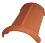
First Nr. 300 Decklänge: ca. 320 mm Deckbreite: ca. 200 mm Bedarf: ca. 3,0 pro m Gewicht: ca. 2,9 kg
