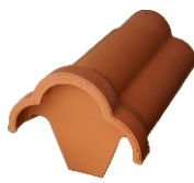
Begin-/eindvorst Nr.1002/1003 Deklengte: ca. 320/340 mm Dekbreedte: ca. 210 mm Gewicht: ca. 4,0/4,9 kg
