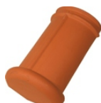
Begin-/eindvorst Nr. 302/303 Deklengte: ca. 330 mm Dekbreedte: ca. 200 mm Gewicht: ca. 3,5/3,4 kg
