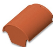
Begin-/eindvorst Nr. 3002/3003 Deklengte: ca. 330/315 mm Dekbreedte: ca. 275 mm Gewicht: ca. 7,7/6,5 kg
