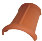
Faîtière Nr. 300 Longueur de couverture: env. 320 mm Largeur de couverture: env. 200 mm Tuiles requises: env. 3,0 par m Poids: env. 2,9 kg
