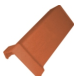
Tuile Faîtière universelle Nr. 6800 Longueur de couverture: env. 400 mm Largeur de couverture: env. 193 mm Tuiles requises: env. 2,5 par m Poids: env. 3,6 kg
