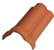
Faîtière Nr. 1000 Longueur de couverture: env. 375 mm Largeur de couverture: env. 210 mm Tuiles requises: env. 2,7 par m Poids: env. 3,4 kg
