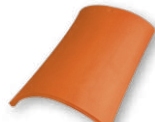
Faîtière conique* Longueur de couverture: env. 360 mm Largeur de couverture: env. 225 mm Tuiles requises: env. 3,0 par m Poids: env. 3,7 kg
