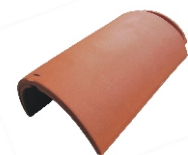
Faîtière Nr. 3000 Longueur de couverture: env. 385 mm Largeur de couverture: env. 275 mm Tuiles requises: env. 2,5 par m Poids: env. 5,0 kg
