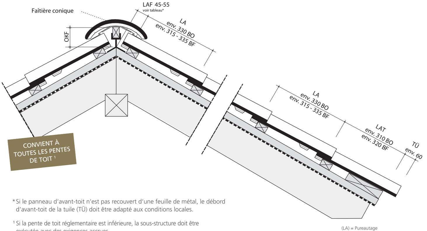
\* Si le panneau d'avant-toit n'est pas recouvert d'une feuille de métal, le débord d'avant-toit de la tuile (TÜ) doit être adapté aux conditions locales.
