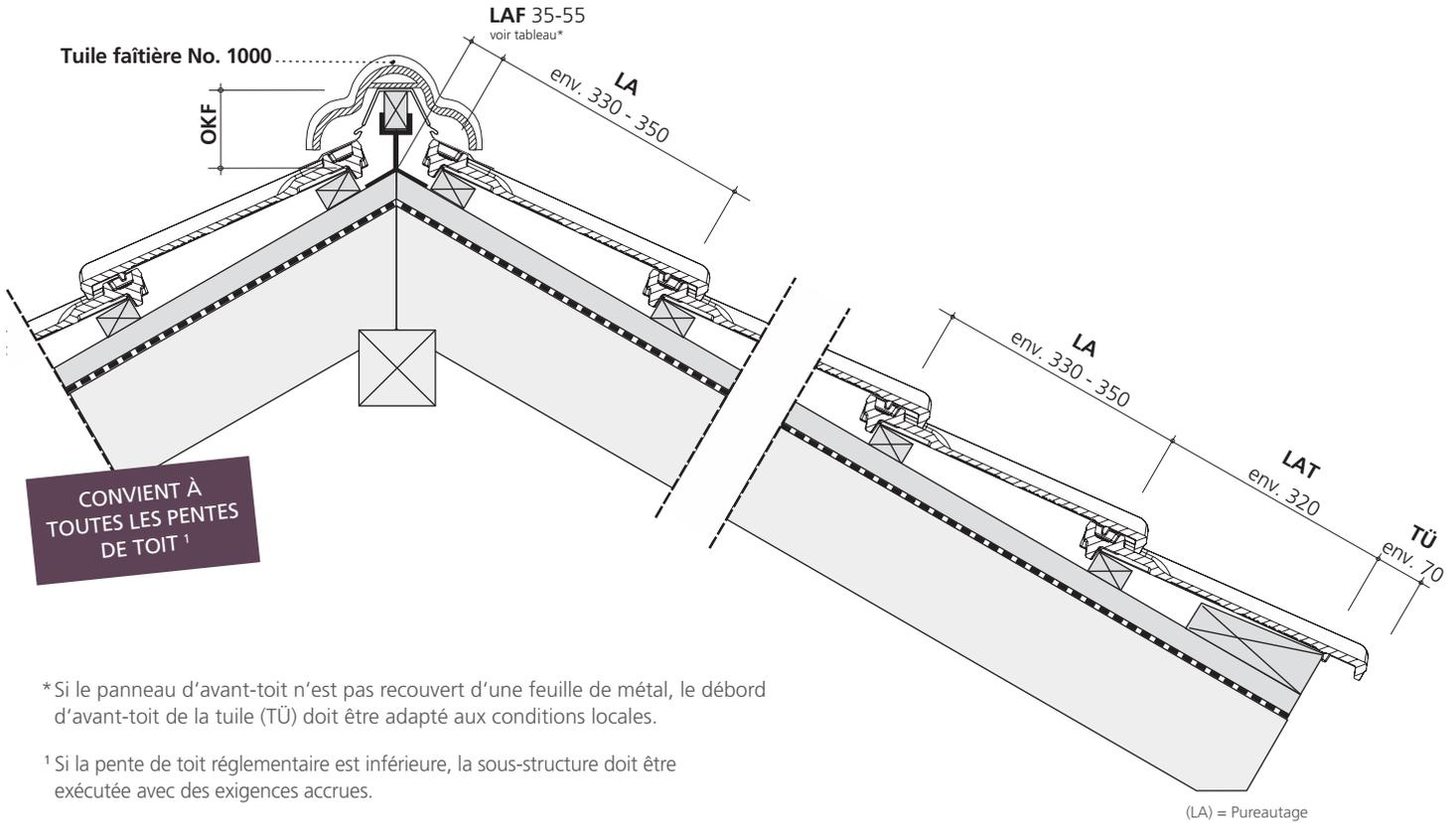
\* Si le panneau d'avant-toit n'est pas recouvert d'une feuille de métal, le débord d'avant-toit de la tuile (TÜ) doit être adapté aux conditions locales.
