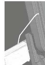
Sturmklammer Nr. 435 Seitenfalzklammer zum Einhängen
