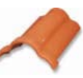
First Nr. 100 Decklänge: ca. 340 mm Deckbreite: ca. 200 mm Bedarf: ca. 3,0 pro m Gewicht: ca. 2,8 kg
