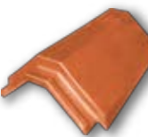
First Nr. 270** Decklänge: ca. 360 mm Deckbreite: ca. 270 mm Bedarf: ca. 2,8 pro m Gewicht: ca. 5,0 kg
