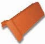
Universal Pultfirst Nr. 6800 Decklänge: ca. 400 mm Deckbreite: ca. 193 mm Bedarf: ca. 2,5 pro m Gewicht: ca. 3,6 kg
