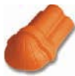
Grat-Anfangsziegel Nr. 1001 Decklänge: ca. 370 mm Deckbreite: ca. 195 mm Gewicht: ca. 3,2 kg
