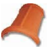
First Nr. 300 Decklänge: ca. 330 mm Deckbreite: ca. 185 mm Bedarf: ca. 3,0 pro m Gewicht: ca. 2,9 kg
