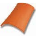
Konischer First* Decklänge: ca. 360 mm Deckbreite: ca. 225 mm Bedarf: ca. 3,0 pro m Gewicht: ca. 3,7 kg
