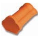
First-Anfangs-/Endziegel Nr. 1002/1003 Decklänge: ca. 315/395 mm Deckbreite: ca. 195 mm Gewicht: ca. 4,0/4,9 kg
