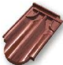
Nr. 9110 Schuppenfalzziegel nach Ludowici Z2 Abmessungen: ca. 390 x 220 mm Decklänge: ca. 255 mm Deckbreite: ca. 200 mm Bedarf: ca. 20 Stk./m 2 Gewicht pro Stk.: ca. 2,7 kg
